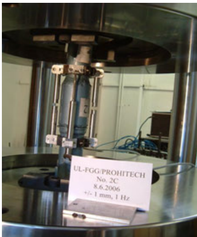
Slika2. Testiranje Dampera na dinamičko opterećenje u Ljubljani.
