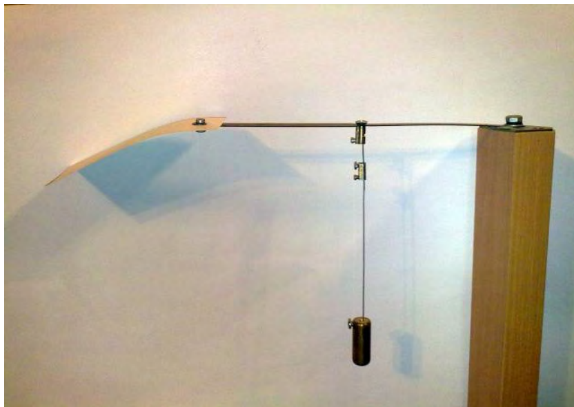
Slika 8. Jedan od brojnih modela sa elastičnim klatnom, čime se ostvaruje duže trajanje oscilacija i veća frekvencija.
