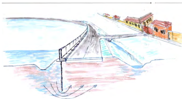
Слика 2. Пут у насипу недовољне висие, надвишен мобилном баријером за управљање поплавом и „побијеном“ филтрационом баријером од пластичне фолије.
