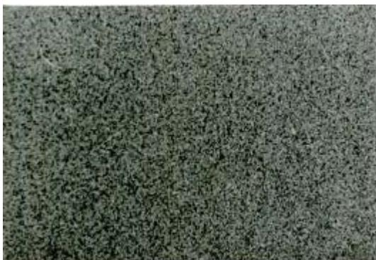
Slika 11. Makrostruktura gornje površine kontinuirano livene trake (x10)
